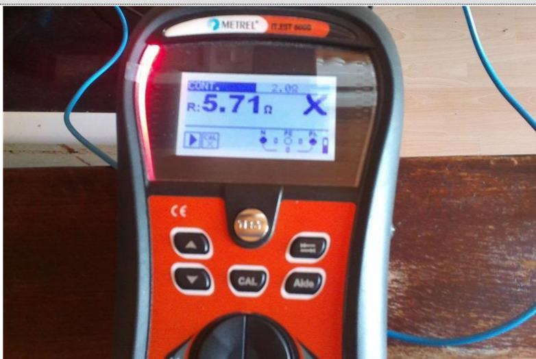
Description : Locaux contenant une baignoire ou une douche : la continuité électrique de la LIAISON EQUIPOTENTIELLE supplémentaire, reliant les ELEMENTS CONDUCTEURS et les MASSES des MATERIELS ELECTRIQUES, n'est pas satisfaisante (résistance > 2 ohms).
