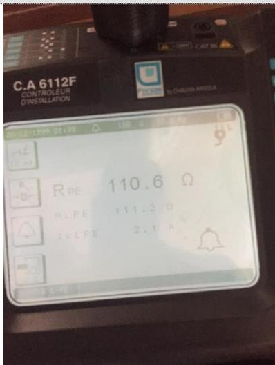
Description : La valeur de la résistance de la PRISE DE TERRE n'est pas adaptée au courant différentiel résiduel (sensibilité) du ou des dispositifs différentiels protégeant l'ensemble de l'installation électrique.
